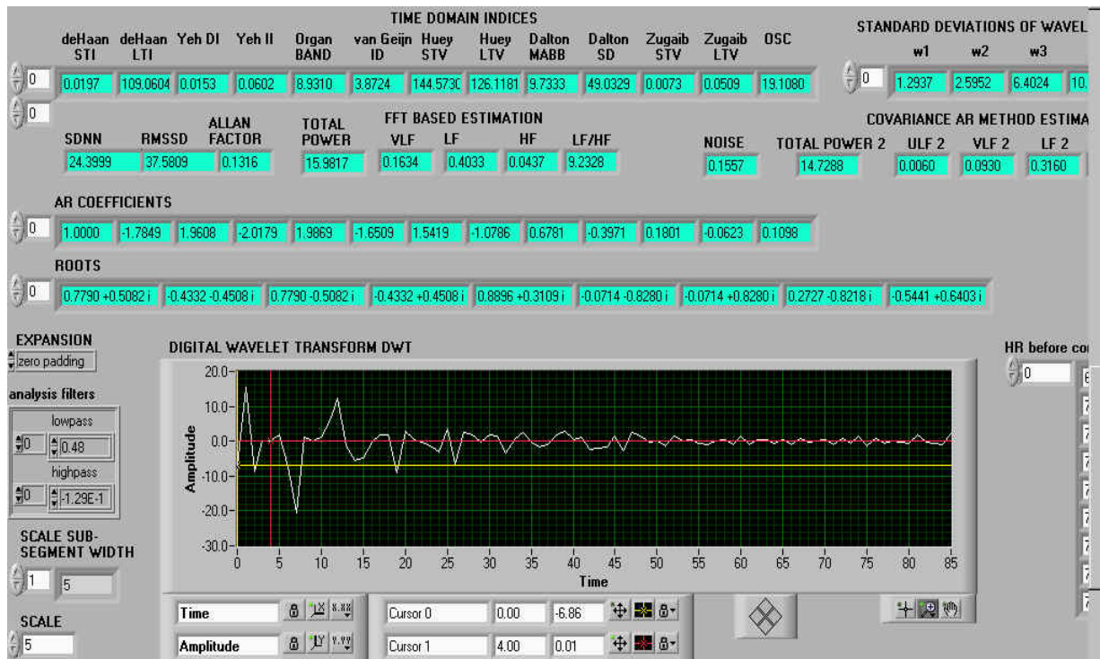
Rys. 2. Fragment panelu narzędzia wirtualnego raportującego wyniki analizy wybranego fragmentu zapisu EKG w dziedzinach czasu, częstotliwości i połączonych dziedzinach czasu-częstotliwości.
